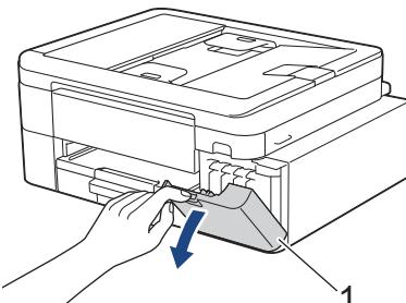
2. Premere la leva di sblocco per sganciare la cartuccia d'inchiostro del colore indicato sul display LCD e rimuovere la cartuccia d'inchiostro dalla macchina, come mostrato nell'illustrazione.
