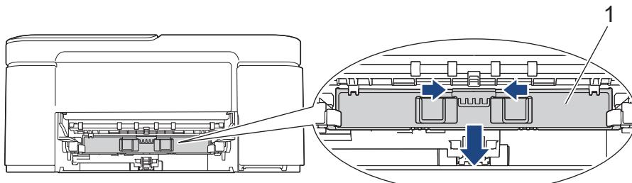
6. Pulire i lati anteriore e posteriore dei rulli di alimentazione (1) con un panno morbido, privo di lanugine e inumidito con acqua, praticando un movimento orizzontale. Una volta completata la pulizia, passare sui rulli un panno asciutto, morbido e privo di lanugine, in modo da rimuovere ogni residuo di umidità.
