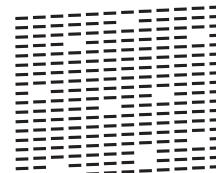
5. Quando sul display LCD appare un messaggio che richiede di controllare la qualità di stampa di ogni colore, premere il numero dello schema (1-4) che più si avvicina al risultato di stampa.
