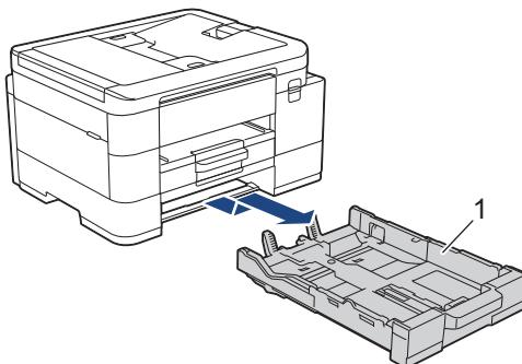
4. Pulire i rulli di scorrimento carta del vassoio n. 2 (1) con un panno morbido, privo di lanugine e inumidito con acqua. Ruotare lentamente i rulli in modo da pulire l'intera superficie. Una volta completata la pulizia, passare sui rulli un panno asciutto, morbido e privo di lanugine, in modo da rimuovere ogni residuo di umidità.
