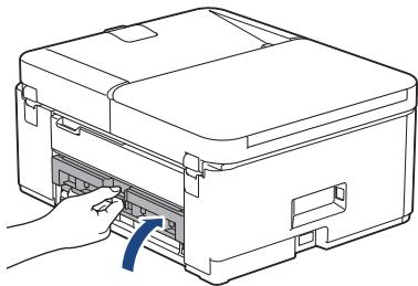
7. Reinserire saldamente il supporto carta nella macchina. Verificare di inserire il supporto carta nei canali.
