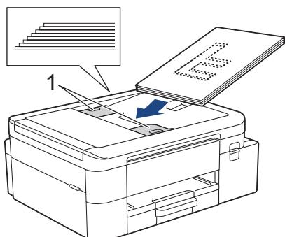
4. Inserire il documento nell'ADF al di sotto delle guide carta, **con la facciata stampata rivolta verso il basso e dal lato superiore**, fino ad avvertire che il documento è a contatto con i rulli di alimentazione e a visualizzare sul display LCD il messaggio [ADF pronto].
