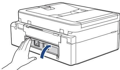
8. Se il messaggio di errore visualizzato sul display LCD era [Inceppamento posteriore], reinserire saldamente il supporto carta nella macchina. Verificare di inserire il supporto carta nei canali.
