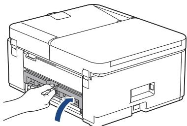
8. Reinserire saldamente il supporto carta nella macchina. Verificare di inserire il supporto carta nei canali.
