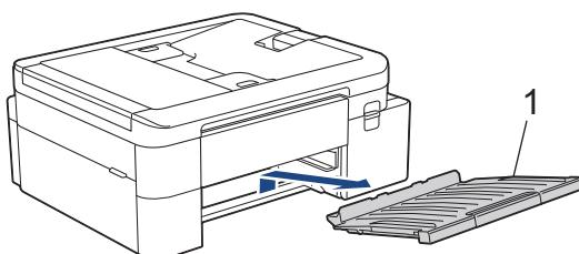
5. Pulire il lato anteriore dei rulli di alimentazione (1) con un panno morbido, privo di lanugine e inumidito con acqua, praticando un movimento orizzontale. Una volta completata la pulizia, passare sui rulli un panno asciutto, morbido e privo di lanugine, in modo da rimuovere ogni residuo di umidità.
