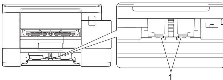
5. Con delicatezza, inserire completamente il vassoio n. 2 nella macchina.
