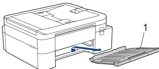
5. Pulire i rulli di scorrimento carta (1) con un panno morbido privo di lanugine inumidito con acqua. Ruotare lentamente i rulli in modo da pulire l'intera superficie. Una volta completata la pulizia, passare sui rulli un panno asciutto, morbido e privo di lanugine, in modo da rimuovere ogni residuo di umidità.
