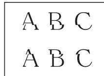
Una volta regolato correttamente l'allineamento di stampa, il testo appare come in questo esempio:
