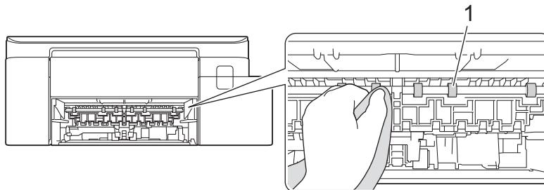
6. Sollevare il supporto ribaltabile (2), quindi pulire il lato posteriore dei rulli di alimentazione (1) con un panno morbido, privo di lanugine e inumidito con acqua. Una volta completata la pulizia, passare sui rulli un panno asciutto, morbido e privo di lanugine, in modo da rimuovere ogni residuo di umidità.
