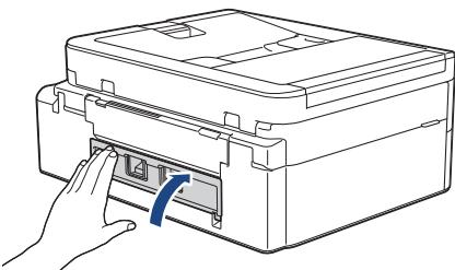
8. Reinserire saldamente il supporto carta nella macchina. Verificare di inserire il supporto carta nei canali.
