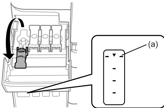
8. Allineare la parte superiore della bottiglia di inchiostro con la porta per il riempimento, quindi inserirla direttamente nella porta per versare l'inchiostro. Il flusso si interrompe automaticamente una volta raggiunta la linea superiore.
