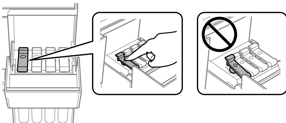
12. Chiudere saldamente il coperchio del serbatoio dell'inchiostro.
