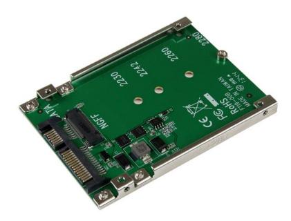
Adattatore SAT32M225 SSD M.2 a SATA che integra la velocità di un'unità SSD M.2 nelle applicazioni con unità SATA da 2,5" per un aumento esponenziale delle prestazioni del Sistema.
