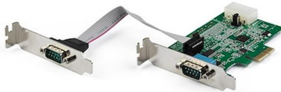
Con questa scheda adattatore seriale RS232 è possibile aggiungere due porte seriali RS232 (DB9) al computer tramite uno slot PCI Express (PCIe), consentendo l'interazione con dispositivi seriali come lettori per schede, stampanti, tastierini PIN e modem, a velocità fino a 921,4 Kbps.
