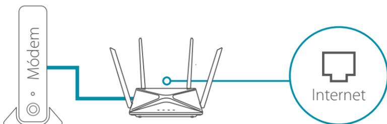
**Nota:** Si el router no incluye un puerto con la etiqueta INTERNET, conecte el cable Ethernet al puerto de LAN 1.
