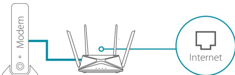
**Notă:** Dacă routerul dvs. nu are un port etichetat INTERNET, conectați cablul Ethernet în portul LAN 1.
