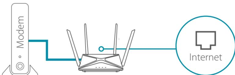
**Poznámka:** Pokud váš router nemá port s označením INTERNET, zapojte do portu sítě LAN 1 kabel sítě Ethernet.
