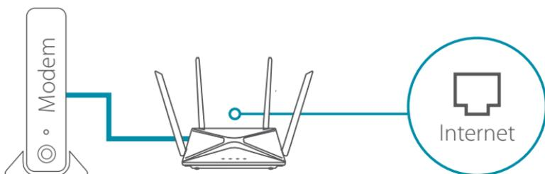
**Obs:** Om din router inte har en port som är märkt med texten INTERNET så koppla in Ethernetkabeln till LAN-port 1.
