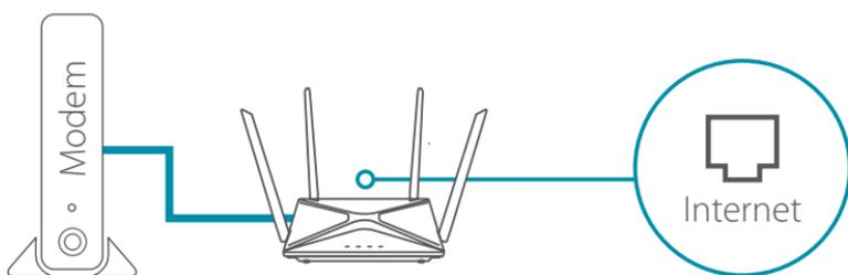
**Bemærk:** Hvis din router ikke har en port mærket INTERNET, sæt da ethernetkablet til LAN Port 1.
