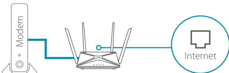
**Opmerking:** Als uw router geen poort heeft met label INTERNET sluit u de ethernetkabel aan op LAN-poort 1.
