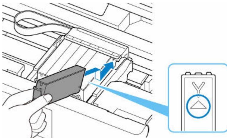
8. Premere sulla parte superiore del serbatoio d'inchiostro finché il serbatoio d'inchiostro non scatta in posizione.
