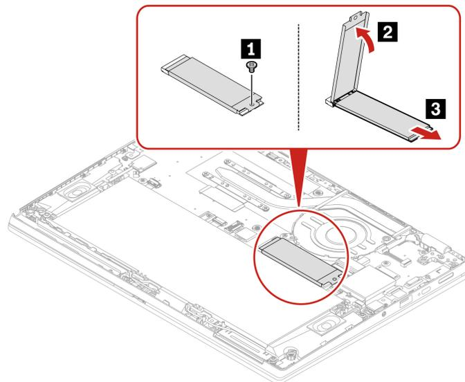
Passo 2. Installare l'unità SSD M.2 come mostrato di seguito.
