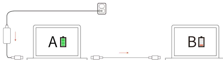
**Nota:** La velocità di caricamento effettiva del computer dipende da molti fattori, come la carica residua della batteria del computer, il wattaggio dell'adattatore di alimentazione CA e se si utilizza il computer.
