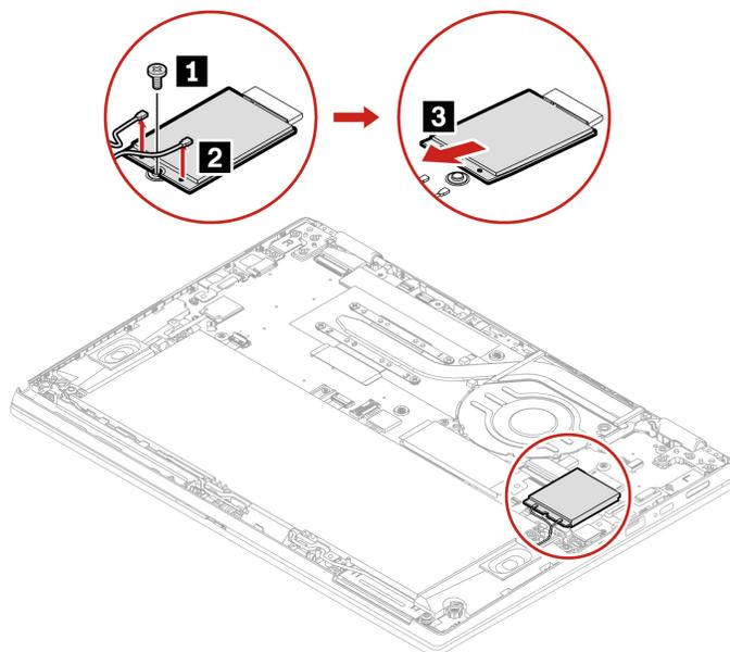
Passo 2. Installare il modulo WWAN come mostrato di seguito.
