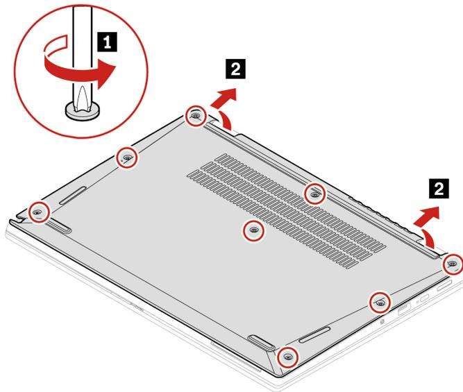
Passo 2. Installare l'assieme del coperchio della base come mostrato di seguito.
