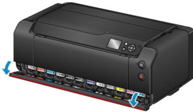
5. Rimuovere il serbatoio d'inchiostro da sostituire.
