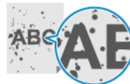
Compaiono sbavature e macchie di toner
