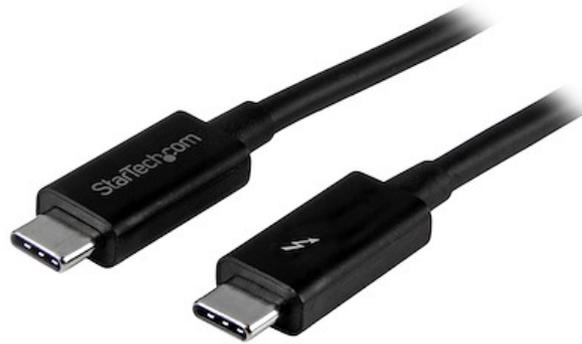
Questo cavo Thunderbolt™ 3 (20 Gbps) consente il collegamento a qualsiasi porta Thunderbolt USB-C (USB-C™) per fornire video e dati ai dispositivi Thunderbolt, USB e DisplayPort. Inoltre, il cavo può fornire l'alimentazione per la ricarica dei dispositivi, permettendo di collegare fino a sei dispositivi Thunderbolt 3 nell'ambito di una connessione a margherita.
