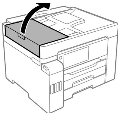
2. Pulire il rullo e la parte interna dell'ADF con un panno morbido e umido.
