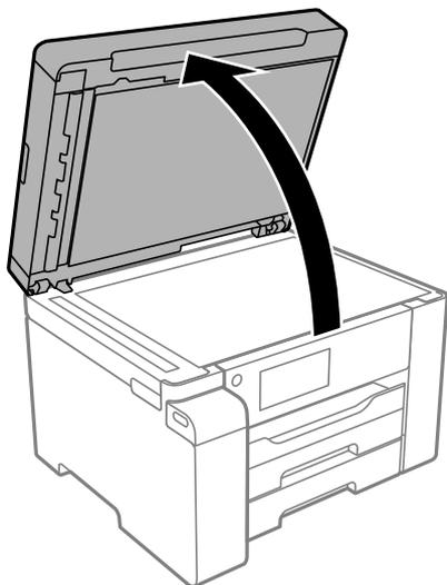
2. Pulire la superficie del vetro dello scanner con un panno morbido, asciutto e pulito.
