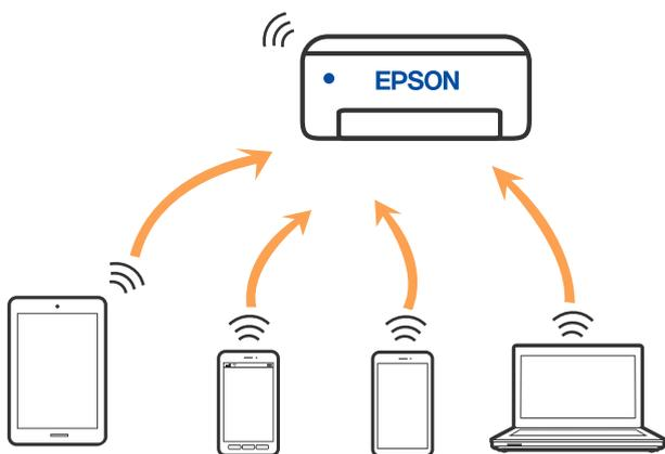
È possibile connettere la stampante simultaneamente tramite Wi-Fi o Ethernet e in modalità Wi-Fi Direct (AP semplice). Tuttavia, se si inizia una connessione di rete in modalità Wi-Fi Direct (AP semplice) quando la stampante è connessa tramite Wi-Fi, la connessione Wi-Fi viene temporaneamente disconnessa.
