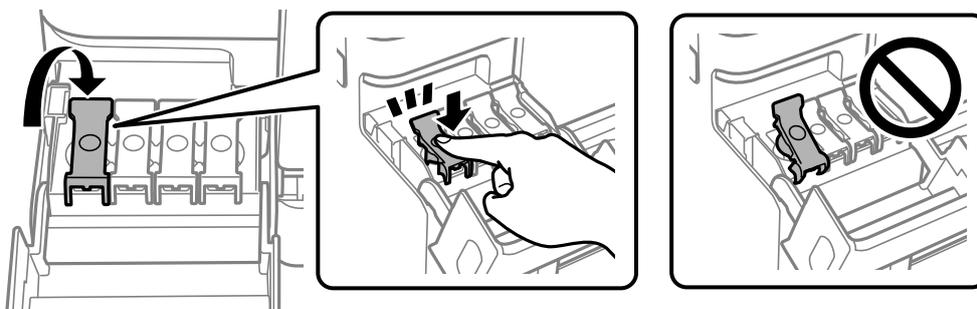
12. Chiudere saldamente il coperchio del serbatoio dell'inchiostro.
