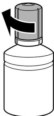
10. Chiudere saldamente il coperchio del serbatoio dell'inchiostro.
