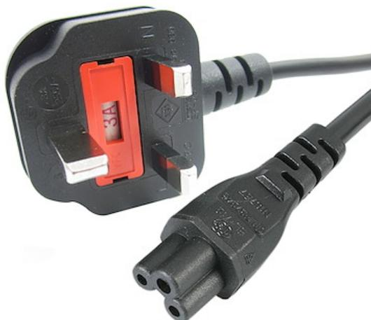
Il cavo di alimentazione per laptop da 1 m PXTNB3SUK1M presenta una spina BS 1363 (tipo G) per il Regno Unito e un connettore C5 a 3 terminali che lo rendono un perfetto cavo di ricambio per laptop HP, Toshiba o altri laptop compatibili dotati di connettore di alimentazione a trifoglio/C5.
