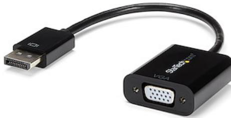
L'adattatore DisplayPort a VGA consente di collegare un computer desktop o laptop con tecnologia DisplayPort a un monitor o a un proiettore VGA, eliminando i costi di acquisto di un display DP.
