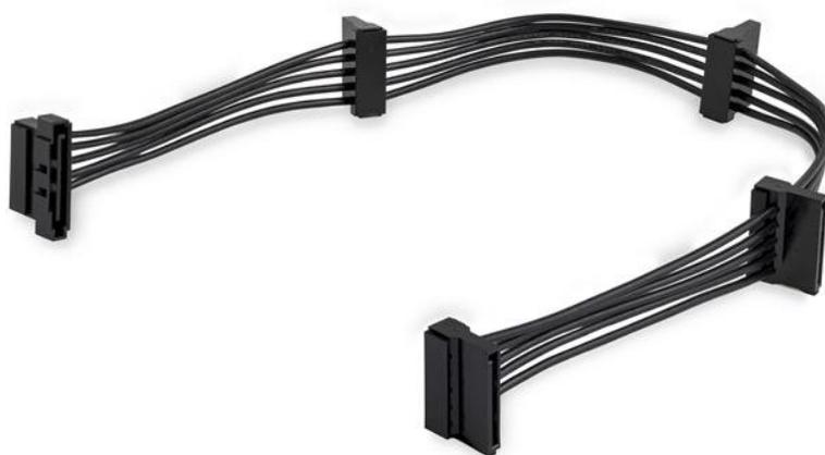
Il cavo splitter per alimentazione SATA PYO4SATA (da 1 a 4) offre un connettore di alimentazione maschio SATA da collegare al connettore SATA dell'alimentatore di un singolo computer e quattro connettori SATA femmina all'estremità opposta.
